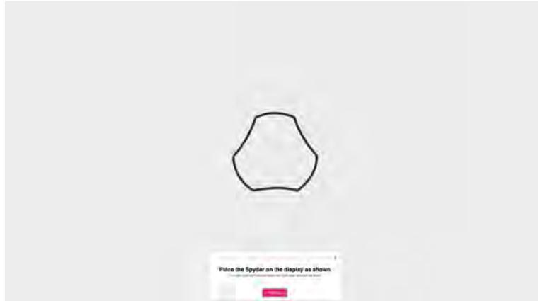
Sigue las indicaciones para colocar tu Spyder/SpyderPro en la pantalla. Retira la tapa del sensor. Se utiliza como contrapeso para que el calibrador permanezca en su sitio y plano contra la pantalla.
