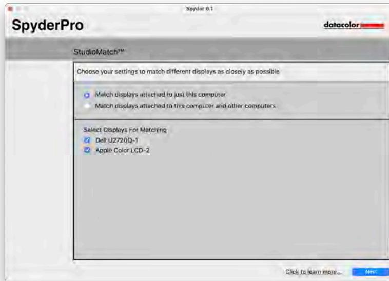
Haz clic en **Siguiente** y sigue las indicaciones para colocar tu SpyderPro en la pantalla para medir el brillo máximo de tus monitores. Asegúrate de que el brillo está ajustado al máximo antes de hacer clic en **Medir**. Haz clic en **Finalizar**.
