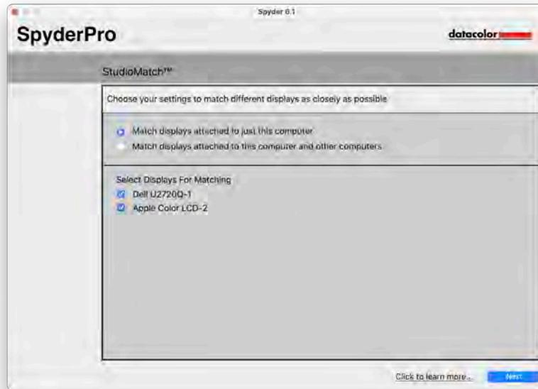
Cliquez sur **Suivant** et suivez les instructions pour placer votre SpyderPro sur l'écran afin de mesurer la luminosité maximale de vos moniteurs connectés. Assurez-vous que la luminosité est réglée au maximum avant de cliquer sur **Mesurer**. Cliquez sur **Terminer**.
