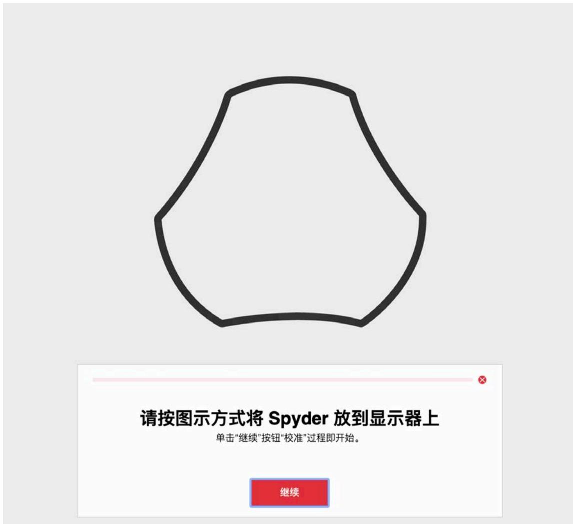
按照提示将 Spyder X2 平放于屏幕上。取下用作配重的传感器保护盖，使校准器保持在合适位置并平放在屏幕上。
