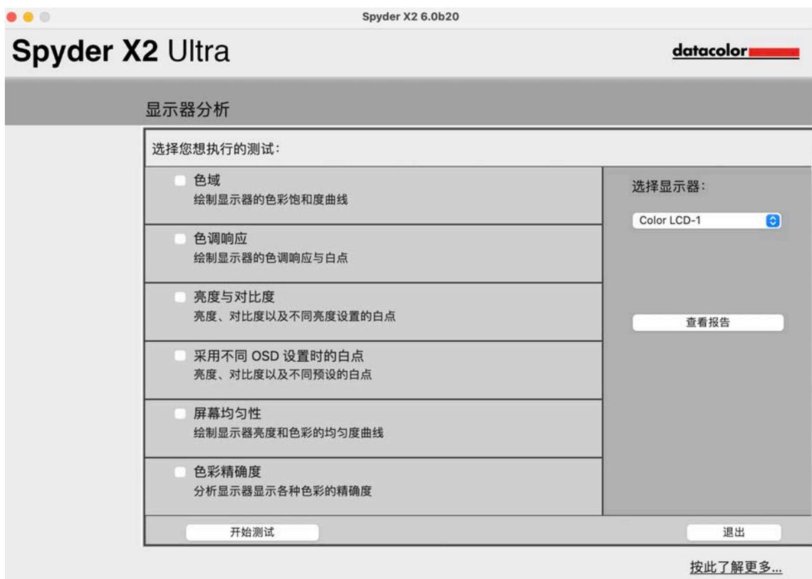
选择要执行的测试，然后单击“开始测试”。按照提示放置传感器并更改显示器的亮度。
