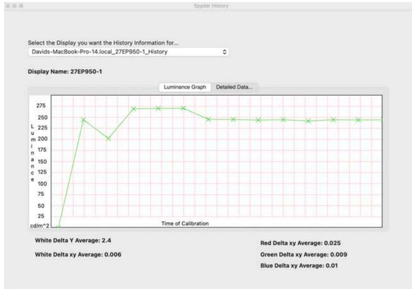
使用下拉式功能表在已保存校準結果的顯示器之間切換。在亮度圖和詳細資料之間切換。以圖形或數值形式查看歷史記錄。
